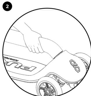
Uchopte tyč řidítek tak, že úplně zatlačíte tlačítka (1) na spodní straně tyče řidítek.
