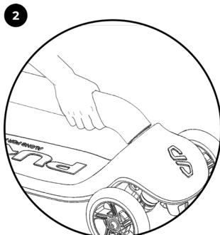
Agarre el manillar presionando completamente el botón (1) de la parte inferior del manillar.
