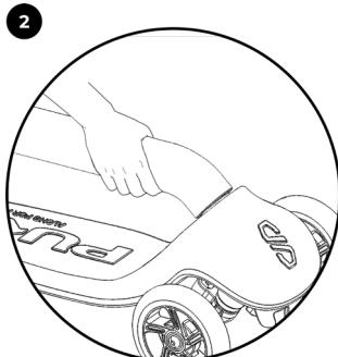
Greifen Sie die Lenkstange so, dass Sie den Knopf (1) an der Unterseite der Lenkstange vollständig eindrücken.
